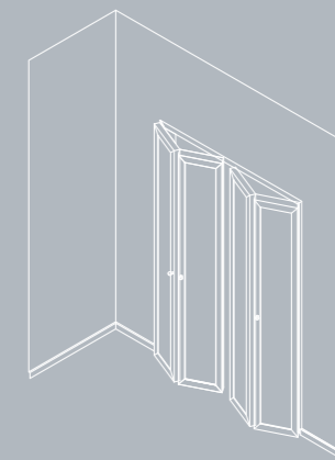
MODULO A LIBRO DOPPIO A 4 ANTE con telaio su 3 lati. Double folding door module, 4 leaves and frame on 3 sides.
