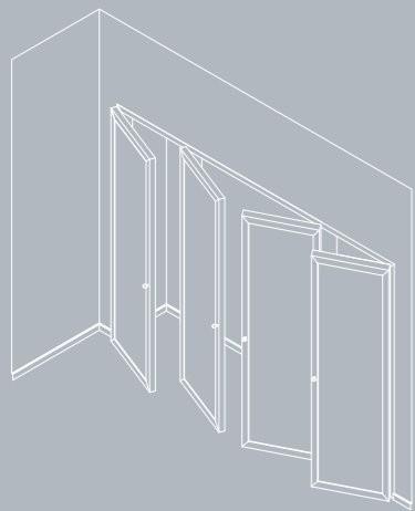
MODULO BATTENTE A 4 ANTE con telaio su 3 lati. 1 modulo doppio + 2 moduli singoli. 4 hinged door module, frame on 3 sides. double module + 2 single module frame.
