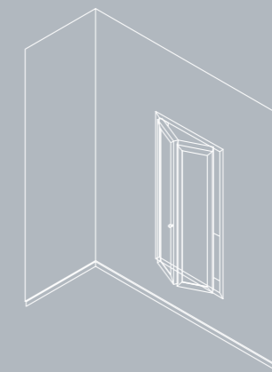
MODULO A LIBRO SINGOLO A 2 ANTE standard con telaio su 4 lati. Single folding door module, 2 leaves and frame on 4 sides.
