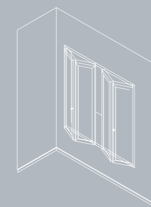
MODULO A LIBRO DOPPIO A 4 ANTE con telaio su 4 lati. Double folding door module, 4 leaves and frame on 4 sides.
