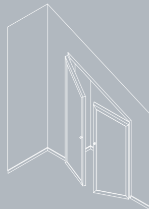
MODULO BATTENTE AD ANTA DOPPIA con telaio obliquo su 3 lati. disponibile anche nella versione con telaio su 4 lati. 2 hinged door module, oblique frame on 3 sides. Available as well on the configuration with frame on 4 sides.
