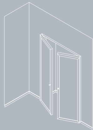
MODULO BATTENTE AD ANTA DOPPIA con telaio su 3 lati. Double hinged door module, frame on 3 sides.
