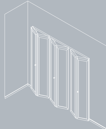
MODULO A LIBRO DOPPIO + MODULO SINGOLO A 6 ANTE con telaio su 3 lati. Double folding door module, 6 leaves and frame on 3 sides.
