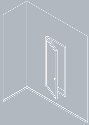
MODULO BATTENTE AD ANTA SINGOLA con telaio su 4 lati. Single hinged door module, frame on 4 sides.
