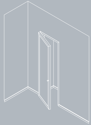
MODULO BATTENTE AD ANTA SINGOLA con telaio su 3 lati. Single hinged door module, frame on 3 sides.
