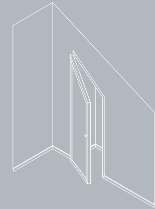
MODULO BATTENTE AD ANTA SINGOLA con telaio obliquo su 3 lati. disponibile anche nella versione con telaio su 4 lati. Single hinged door module, oblique frame on 3 sides. Available as well on the configuration with frame on 4 sides.
