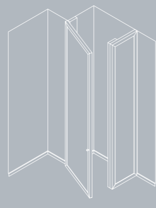
MODULO BATTENTE AD ANTA SINGOLA con fianco singolo. Single hinged door module, single side frame.
