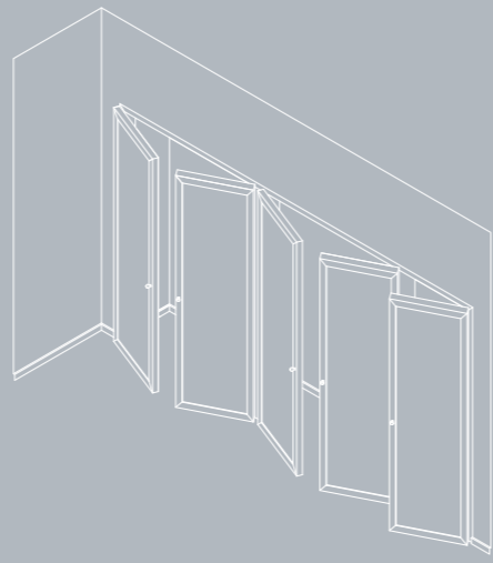
MODULO BATTENTE A 5 ANTE con telaio su 3 lati. 2 moduli doppi + 1 modulo singolo. 5 hinged door module, frame on 3 sides. 2 double module frame + a single module.
