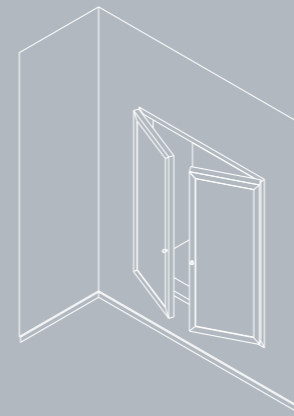
MODULO BATTENTE AD ANTA DOPPIA con telaio su 4 lati. Double hinged door module, frame on 4 sides.
