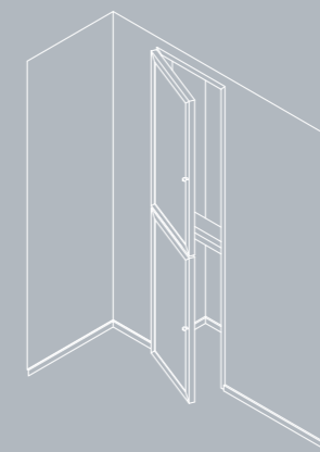
MODULO BATTENTE AD ANTA SINGOLA con doppio telaio su 3 lati. Single hinged door module, frame on 3 sides.
