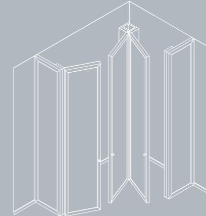
MODULO BATTENTE AD ANTA DOPPIA CON FIANCO FORMANTE UNA "L" CON UN MODULO AD ANTA SINGOLA con telaio su 4 lati. Double hinged door module, "L" type with single door module, frame on 4 sides.
