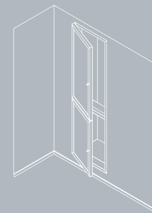
MODULO BATTENTE AD ANTA SINGOLA con doppio telaio su 4 lati. Single hinged door module, frame on 4 sides.
