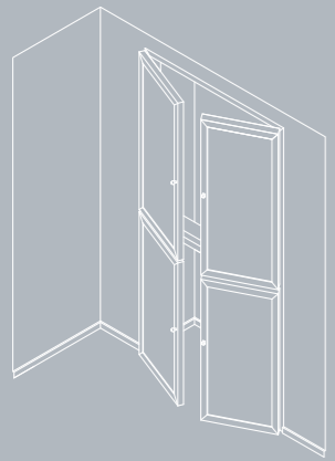
MODULO BATTENTE AD ANTA DOPPIA con doppio telaio su 3 lati. Double hinged door module, double frame on 3 sides.
