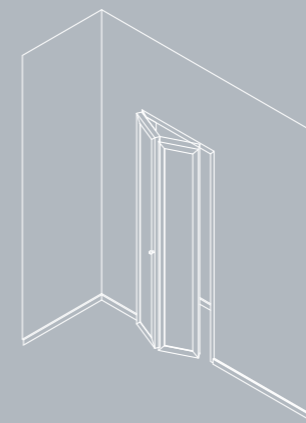
MODULO A LIBRO SINGOLO A 2 ANTE standard con telaio su 3 lati. Single folding door module, 2 leaves and frame on 3 sides.
