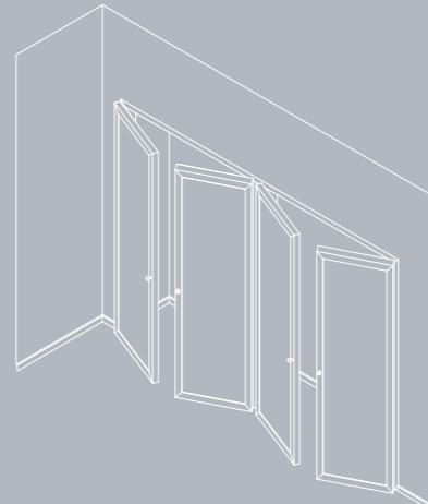
MODULO BATTENTE A 4 ANTE con telaio su 3 lati. 2 moduli doppi. 4 hinged door module, frame on 3 sides. 2 double module frame.
