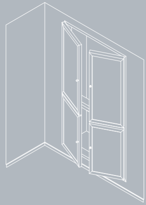
MODULO BATTENTE AD ANTA DOPPIA con doppio telaio su 4 lati. Double hinged door module, double frame on 4 sides.
